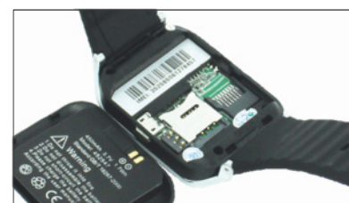
Der Einsatz einer SIM-Karte macht die Enox SWP55 unabhängig vom Smartphone
